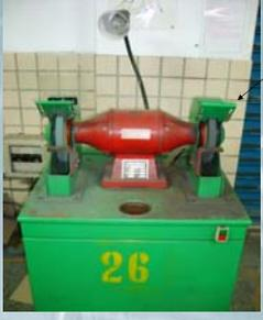
在砂輪機設置防護罩可以防止碎裂物品濺飛而傷害自己
