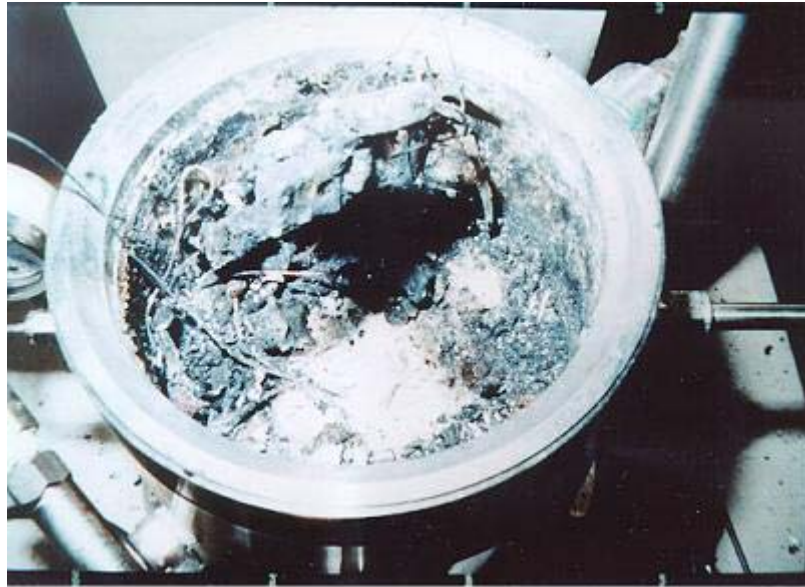
圖 3.3 損壞後之絕熱測試儀器俯視圖
