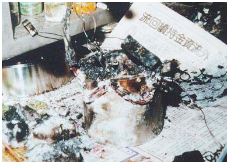
圖 3.4 事故發生後損壞之絕熱測試罐外觀圖
