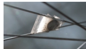
圖 4 前輪幅條上的強力磁鐵
