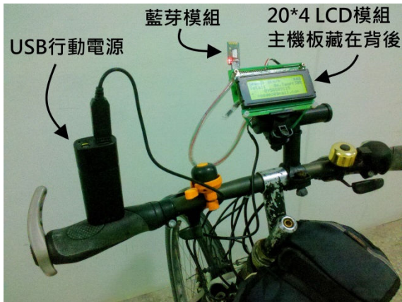
圖 13 實際裝設於單車上的情形
