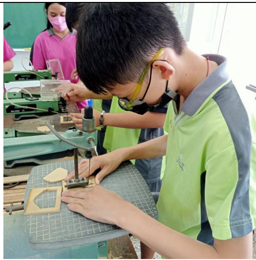
線鋸機鋸切加工
